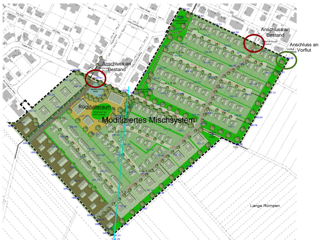
Abbildung 12: Variante 3, Entwässerung im modifizierten Mischsystem
