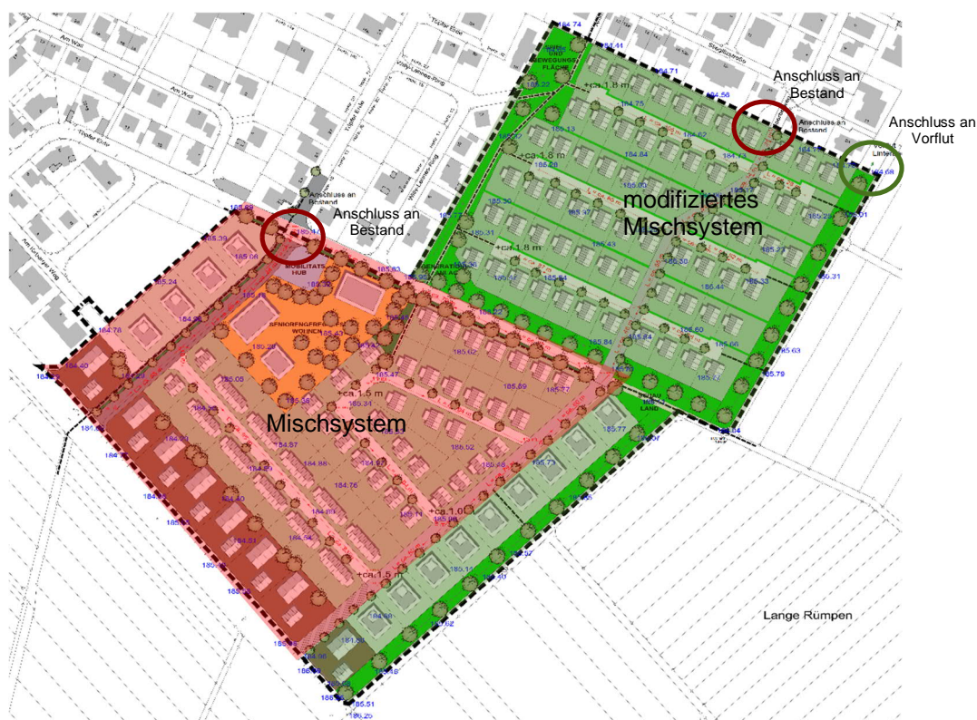
Abbildung 10: Variante 2, Entwässerung im Mischsystem, teilweise modifiziert
